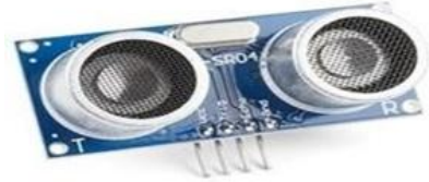
الشكل (3): يوضح جهاز استشعار بالموجات فوق الصوتية (Deepa and others 2025).
