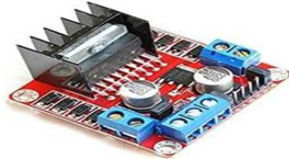
الشكل (4): يوضح قائد المحركات L289N (Amit and others ,2013)
